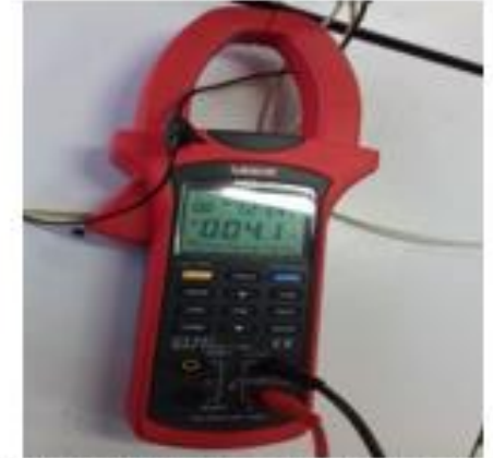
Figura 25 Medición de corriente mínima al estar activo al 100%.
