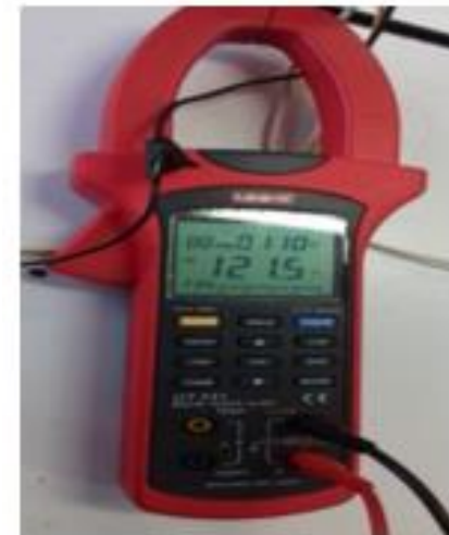
Figura 24 Medición de voltaje.
