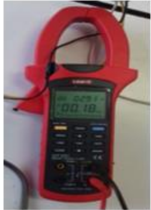
Figura 27 Medición de potencia en arranque suave de 180 W.
