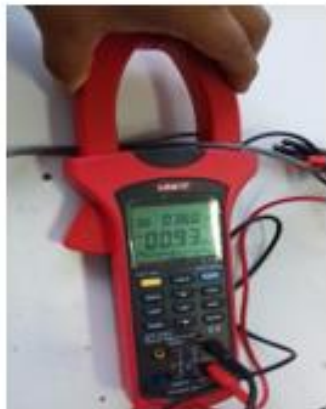
Figura 28 Medición de potencia en arranque directo de 930 W.
